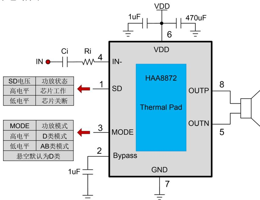
**AB 类/D 类切换 10W 输出功率 单通道音频功率放大器**
